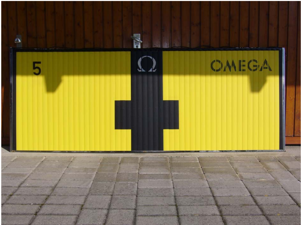
6 Anschlagmatten, hier Bahn 5
